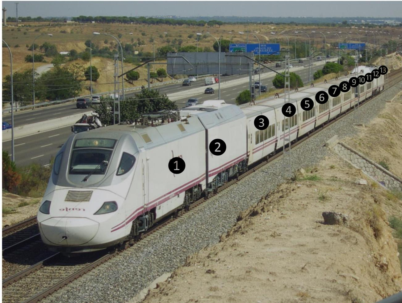
Funciona en diferentes anchos de vía, con propulsión diesel o conectado a la catenaria 25000V AC/3000V DC, y es una modificación de la serie 130, dotado de Sistema ERTMS(ETCS), LZB, ASFA Digital y STM-EBICAB.
